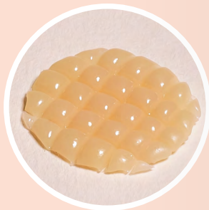
Микрорельеф поверхности неотвержденного композита РеЛайт® после выдержки при 37 °С в течение 20 минут
